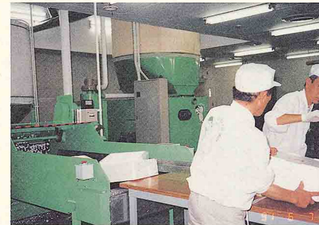
生鮮センターに併設したリサイクル工場で行っている発泡スチロールリサイクル。減容して5kgほどの再生プラスチック原料に加工します。
