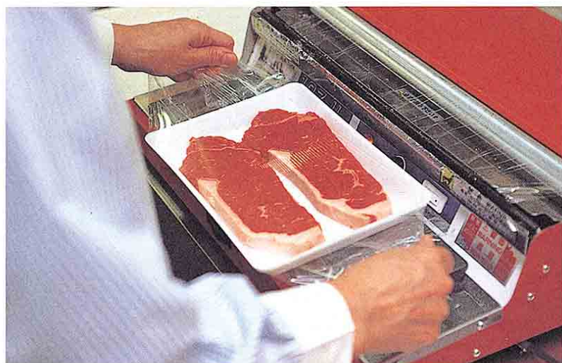
全店で店内加工の生鮮食品用ラップを、非塩ビ系のポリオレフィン・フィルムに転換
